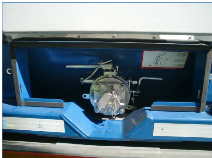
Vollständig verschlossener Auslaufbereich mit Bodenventil DN 80 Fort Vale mit 3" BSP-Gewinde
