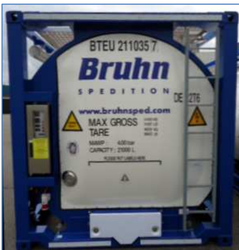
Vollständig verschlossener Auslaufbereich mit Bodenventil DN 80 Fort Vale mit 3" BSP-Gewinde
