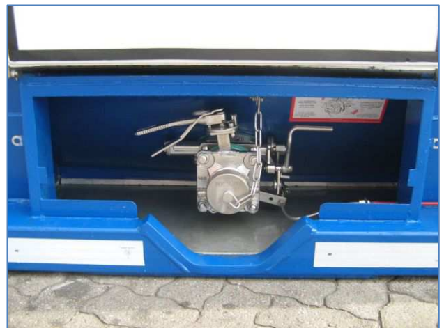
Bodenventil DN 80 Fort Vale mit 3" BSP-Gewinde und beheizbarem Bodenflansch
