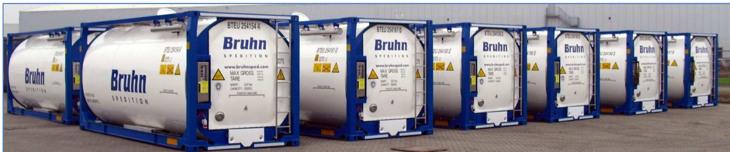
Tankcontainer mit Spezialisierung und GFK-Verkleidung
