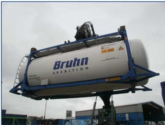
32.000 Liter Swap-Tank mit Spezialisolierung
