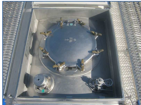
2 x isolierter Dombereich mit Deckel
