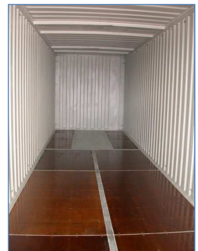
Innenraum mit Plywood-Holzfußboden
